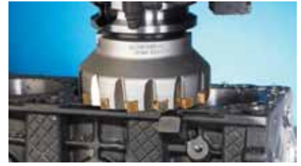
Desbaste en Fundición
