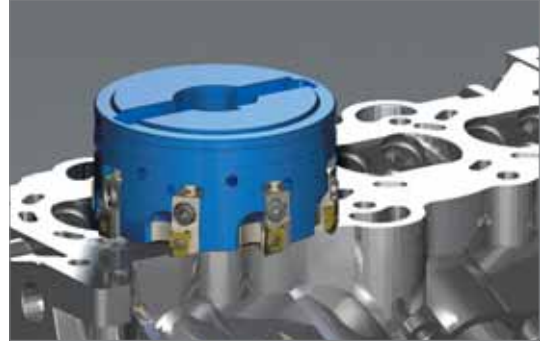
Cara Superior (Desbaste y Acabado) - Aero Mill
