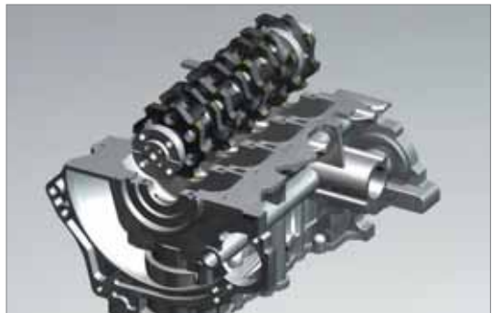
Corte base de cojinetes - Cortador de Cuadrilla
