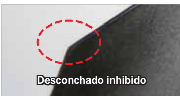
Menos desgaste y descamado en la superficie del filo
