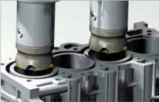
Perforación de cilindro(Desbaste) - Cortador de barrenar
