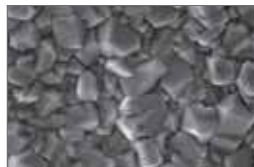
Recubrimiento de diamante existente
